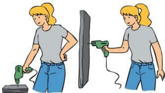
Una herramienta de empuñadura recta es adecuada para trabajar sobre una superficie horizontal a la altura del codo o sobre una vertical por debajo de la cintura. Si es utilizada sobre una superficie horizontal por debajo del codo o sobre una vertical a la altura del codo, produce desviación cubital de la muñeca.
