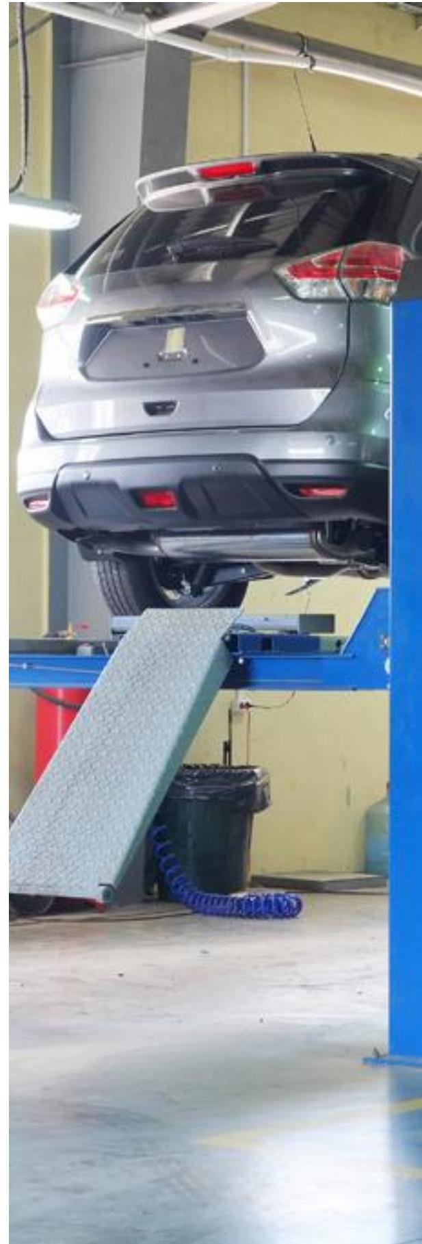
En los elevadores de dos columnas simétricos las puertas de los vehículos normalmente quedan posicionadas delante, permitiendo al operario situar el vehículo centrado entre las columnas y abrir las puertas. Ver figura 11.
