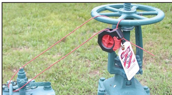
PSL-1008 Dispositivo de bloqueo con cable de 1.82 m Carrete que enrolla el cable. Asegura varios dispositivos en forma rápida y segura: alargue e introduzca el cable a través de varios dispositivos e inserte el extremo de vuelta para ceñirlo. Al ajustar el cable, se asegura con un candado de bloqueo.
