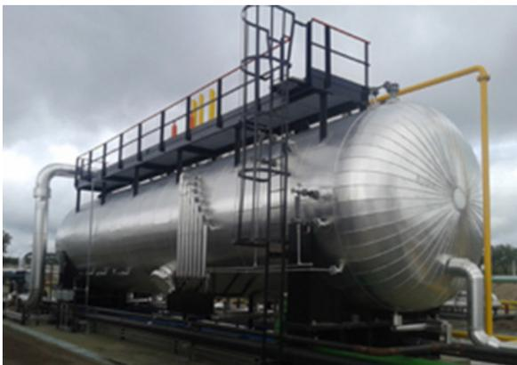
Ejemplo de separador. Fuente: <http://www.premasa.com.ar/images/productos/water/img-front.jpg>
