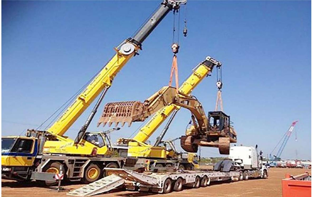
**Fotografía 9.** Izaje de carga con dos grúas móviles con brazo telescópico y montada en ruedas. **Fuente:** Rumbo Minero Internacional, 2017.
