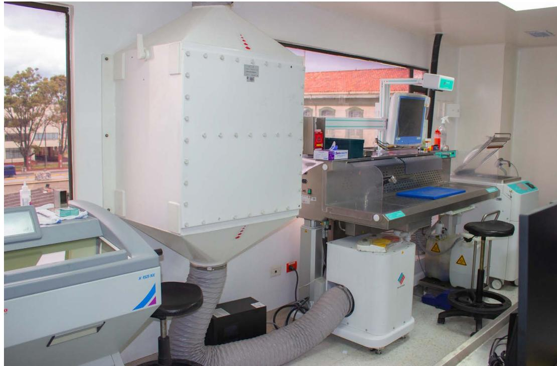
Por un lado, cuentan con cámaras de absorción alrededor de la muestra que capturan los vapores de formaldehído, un sistema de evacuación hermético y rejillas de ventilación que, en conjunto, crean un flujo de aire continuo y seguro reduciendo así la exposición al peligro químico por concentraciones en el ambiente.
