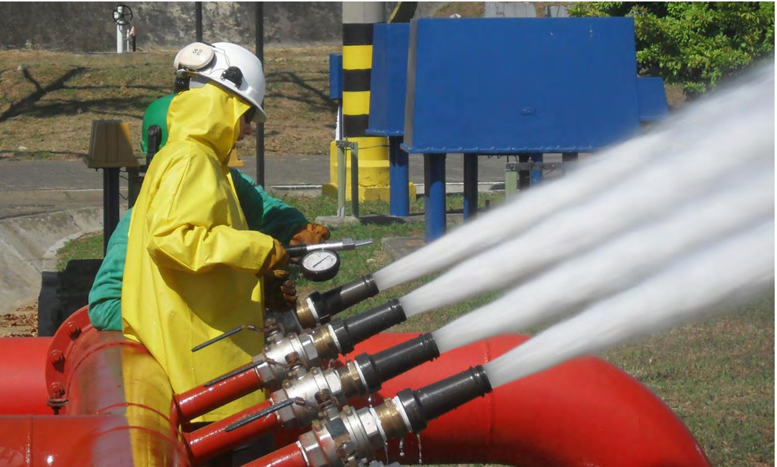
**Foto:** medición de caudal utilizando tubos pitot en cabezal de pruebas. **Fuente:** fotografía tomada por el autor. Ecopetrol, Terminal Coveñas. 2011.
