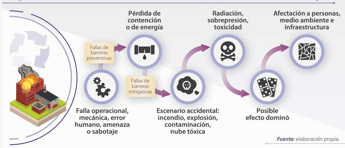
Figura 6. Dinámica accidental de un incidente industrial por pérdida de contención o energía
