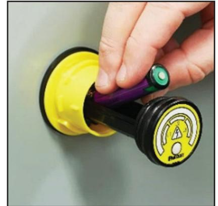
**10.** Coloque la batería. Para obtener más detalles, consulte la sección Reemplazo de la batería del manual.
