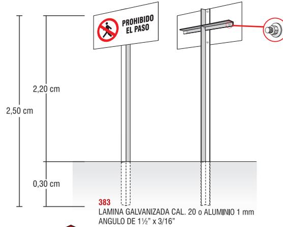
**TODAS NUESTRAS SEÑALES EN PEDESTAL ESTAN RECUBIERTAS CON PINTURA ELECTROSTATICA**
