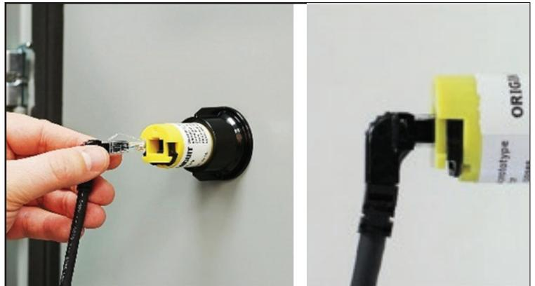
**5.** Inserte el extremo del cable de sistema del AVT con el conector de ángulo recto en la parte posterior del módulo del indicador. Presione firmemente hacia el interior de la abertura hasta que sienta que haya calzado. Tire del conector para asegurarse de que haya calzado correctamente.
