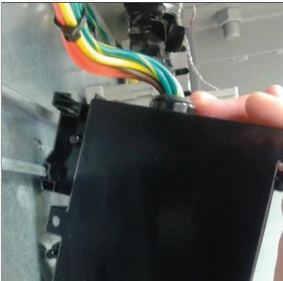
**4.** Calce el módulo de aislamiento en el carril DIN. De manera alternativa, el módulo de aislamiento se puede montar en cualquier superficie con tres tornillos de cabeza alomada #8 u otro elemento de sujeción compatible. Se recomienda el montaje en superficie con tornillos en entornos con muchas vibraciones.
