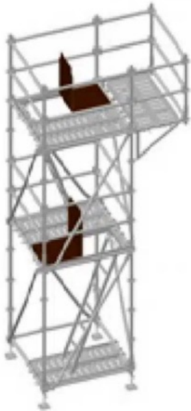
Figura 21. Andamio con voladizo
