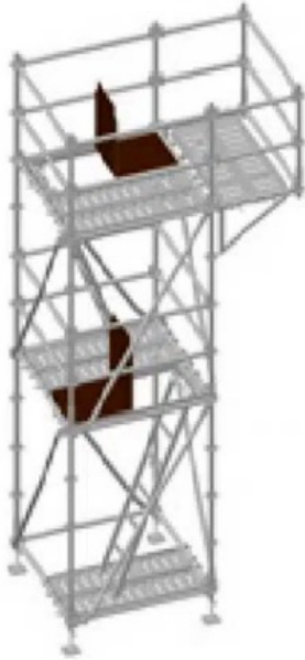
Figura 21. Andamio con voladizo
