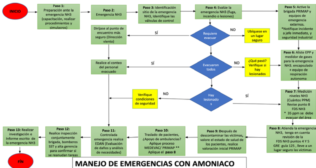
Figura 9. Procedimiento operativo. Atención de emergencias con NH 3
